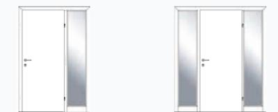
1 Seitenteil rechts/links, Türblatt rechts/links angeschlagen
