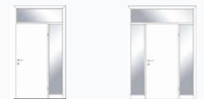
1 Seitenteil rechts/links, 1 Oberteil, Türblatt rechts/links angeschlagen
