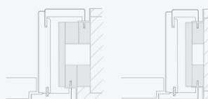
**MAGNETFALLE:** Optional erhalten Sie auch ein Magnetfallenschloss. Hierbei wird die Schlossfalle durch einen in der Zarge integrierten Magneten angezogen.
